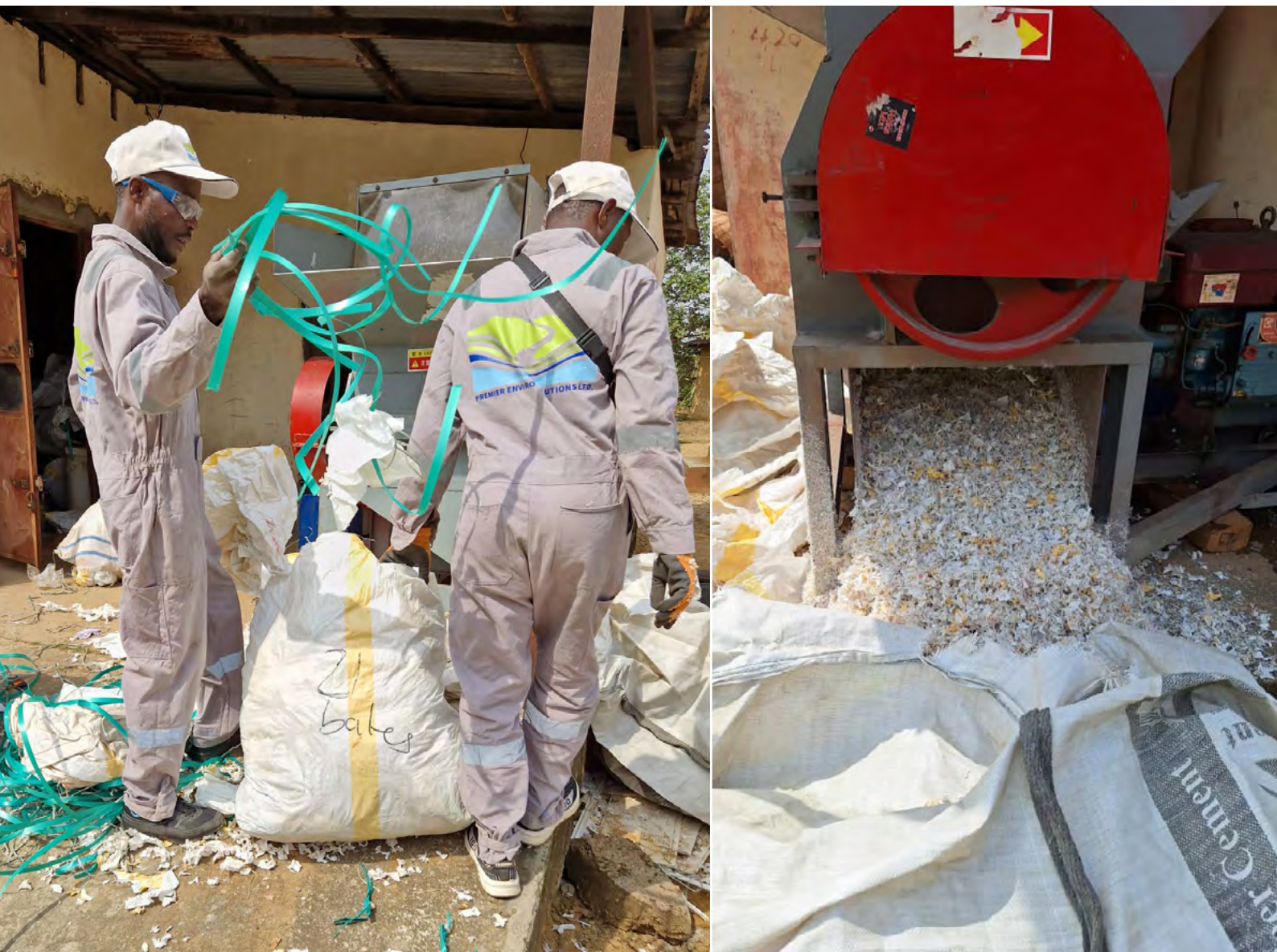
Figure 5 : Broyage des déchets de MII en paillettes
