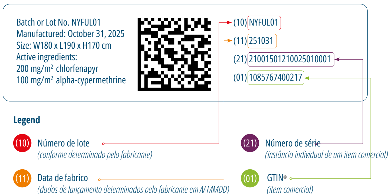
Figura 1: Etiqueta aplicada a um MTI individual (com legenda apenas para efeitos ilustrativos)
